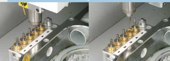
Fünffacher automatischer Werkzeugwechsler erhöht Produktionskomfort
